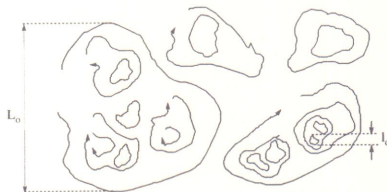
Figure 2: Représentation des tourbillons générant la turbulence atmosphérique et caractérisation des échelles externe et interne.
